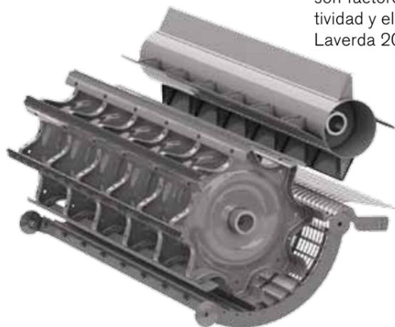
cosechadora. Por eso, junto a los prestigiosos órganos trilladores clásicos, Laverda propone el **módulo REV** compuesto por el post-trillador (**tambor REV**) y por el alargue del contratrillador (**segmento REV**), regulable en 3 posiciones diferentes, componente ideal por su versatilidad y por su polivalencia de uso.
